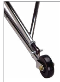
Sprung or unsprung wheelie bars; 52" or 84" length
