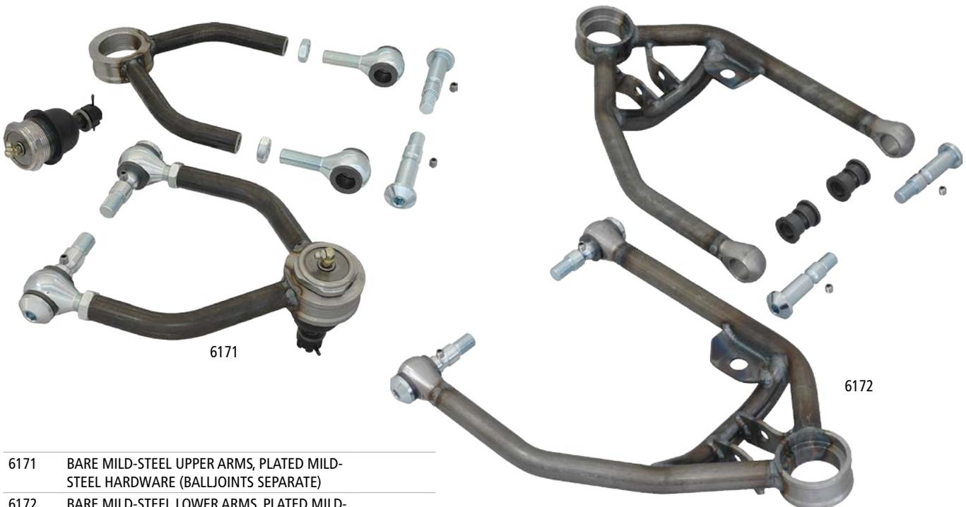
6171 BARE MILD-STEEL UPPER ARMS, PLATED MILD-STEEL HARDWARE (BALLJOINTS SEPARATE)
